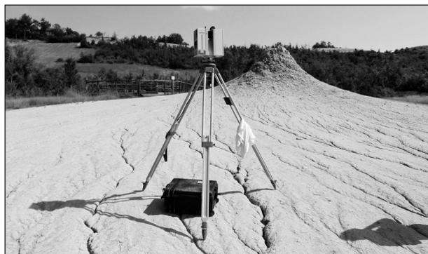
Fig. 1 – Il laser scanner Leica HDS 7000 in fase di acquisizione dei dati durante la prima campagna di rilievo del settore “Salsa E-Egidio” (giugno 2015).
