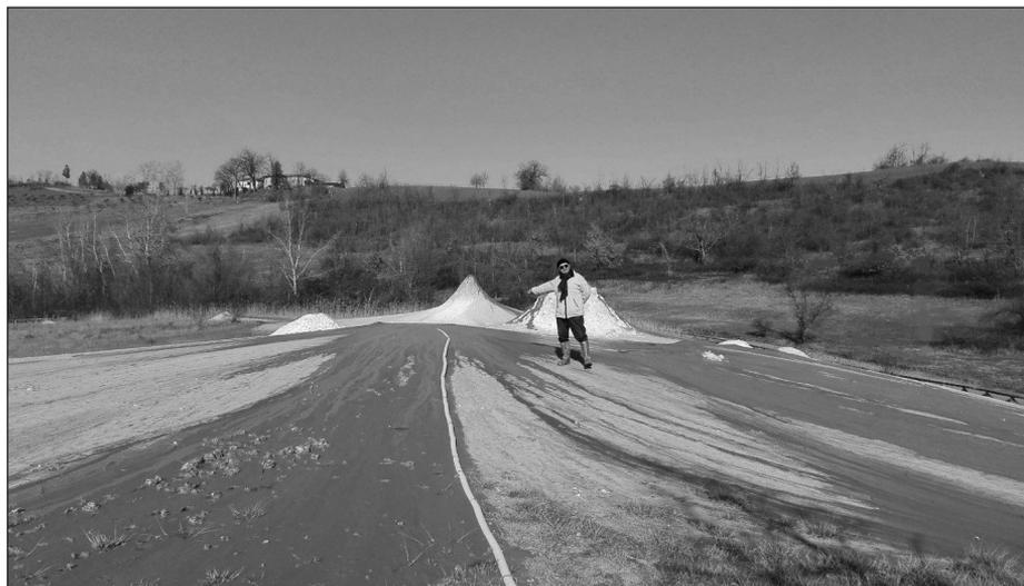
Fig. 1 – Polla del complesso luvivomo “D-La Giunta” in cui è installata la sonda di livello e temperatura. In evidenza il cavo per l’acquisizione a distanza dei dati.
