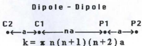
**Figura 3.4.1** Schema di acquisizione secondo la geometria dipolo-dipolo, con C1 e C2 sono rappresentati gli elettrodi di corrente, mentre con P1 e P2 sono rappresentati gli elettrodi di potenziale. Questo tipo di misura ha una buona risoluzione laterale, ma il segnale è più debole rispetto alle altre geometrie di acquisizione.
