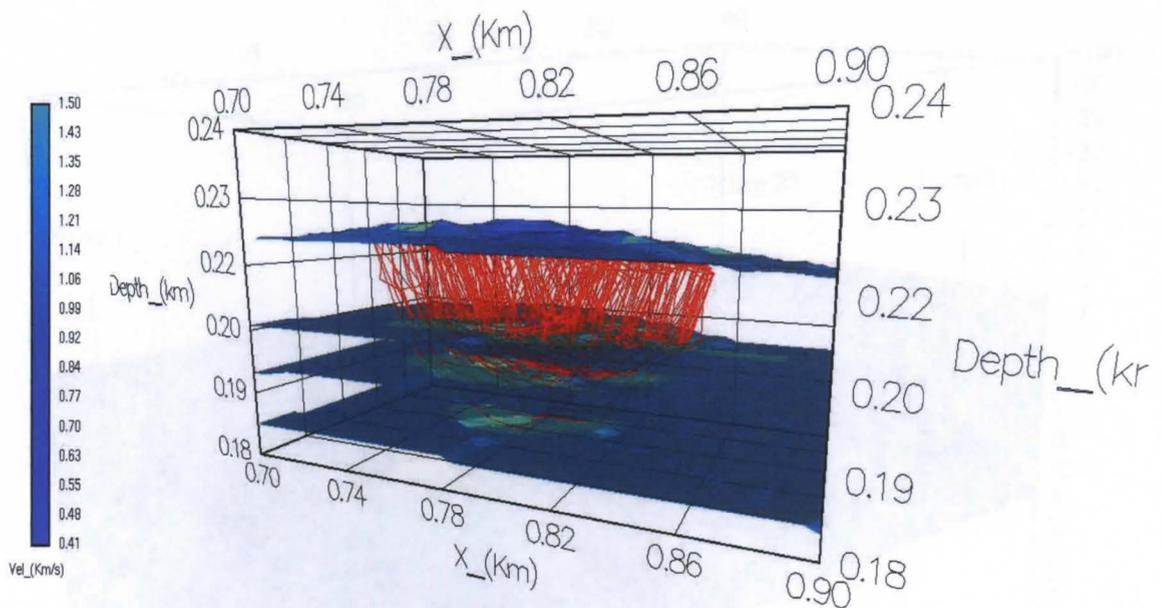
**Fig. 16.** Visualizzazione del ray-tracing dei primi arrivi.
