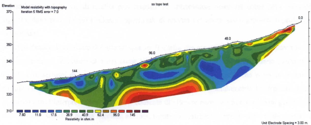
Figura 3.5.10 Modello di resistività della linea SS\_01e\_05.
