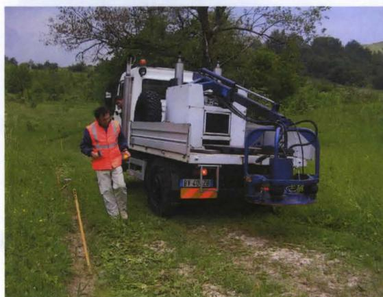
**Fig.2.** *Acquisizione a Nirano utilizzando il Vibroseis*
