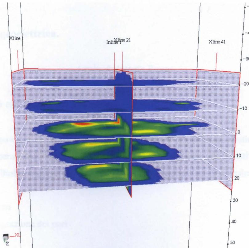
**Fig. 18.** Sezioni piano-parallele del cubo di velocità ottenuto dall'inversione tomografica, in cui è evidente la presenza di un serbatoio di fluidi attorno a 30-40 metri di profondità e la natura sub-verticale del camino.
