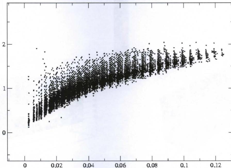
Fig. 9. Grafico delle velocità apparenti dei primi arrivi. In ordinate sono rappresentate le velocità (km/s), mentre in ascissa è indicato l'offset (km).
