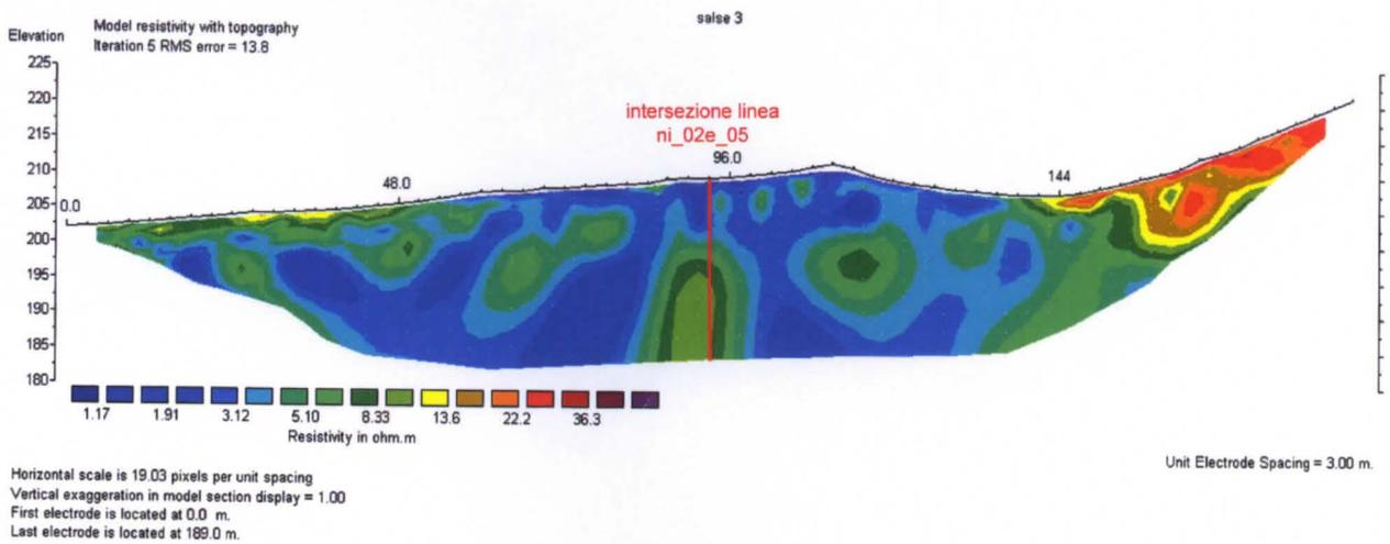
Figura 3.5.7 Modello di resistività della linea Ni\_03e\_05.
