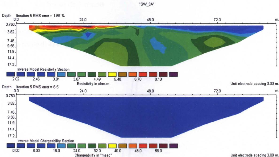
Figura 3.4.4 Modelli di resistività (in alto) e di caricabilità (in basso) della linea test, acquisiti con la geometria Wenner-Schlumberger.
