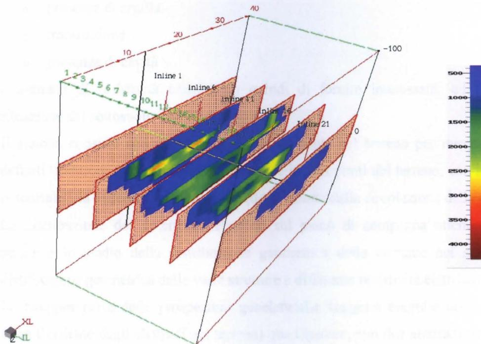
**Fig. 19.** Sezioni del campo di velocità lungo le linee dei geofoni. Da osservare l'anomalia centrale con bassa velocità, che corrisponde al serbatoio di fluido.
