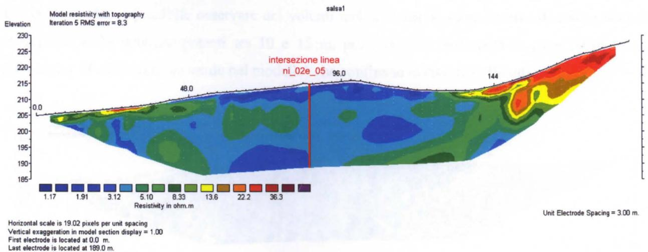
Figura 3.5.3 Modello di resistività della linea Ni\_01e\_05.
