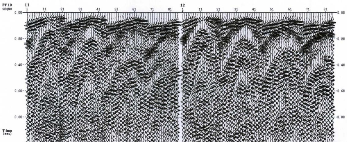
**Fig. 13** *Esempio di due scoppi registrati dalle componenti verticali dei geofoni.*
