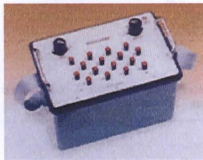
Figura 3.2.1 Resistivimetro Syscal R2 (sopra). Box del sistema multinode (sotto).
