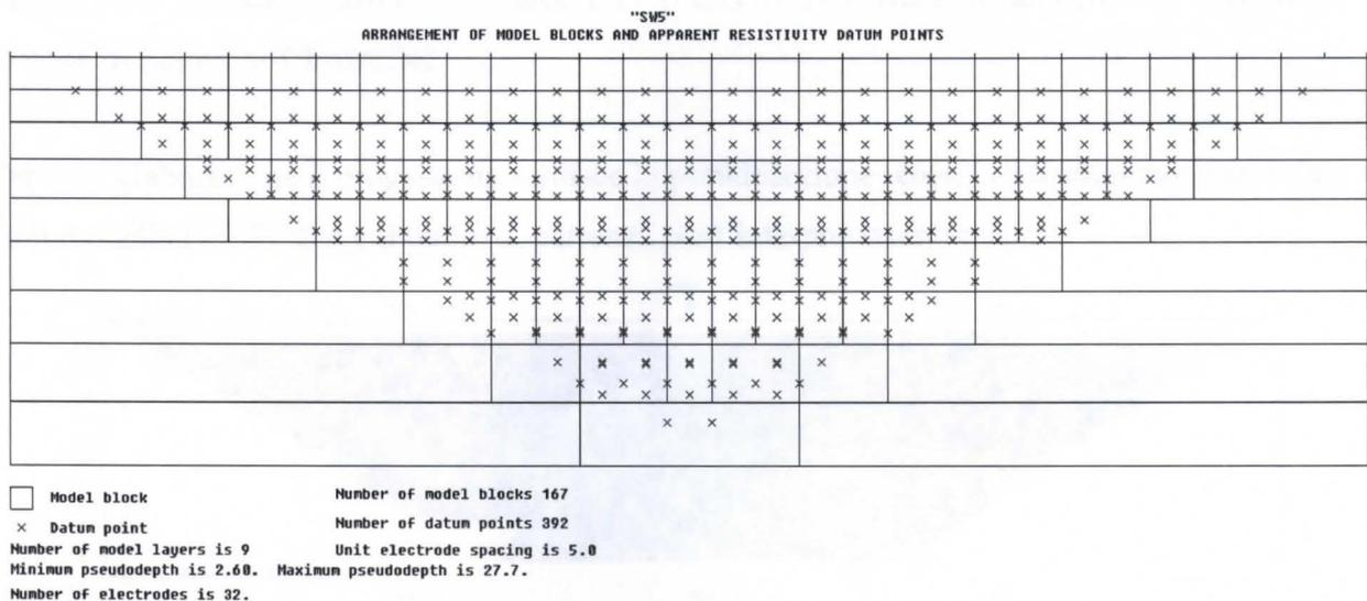
Figura 3.3.1 Disposizione dei blocchi e dei punti di misura ottenuti utilizzando una sequenza di acquisizione Wenner-Schlumberger completa.
