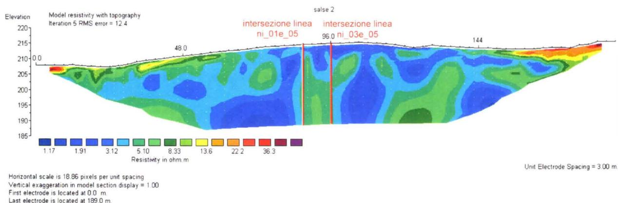
Figura 3.5.5 Modello di resistività della linea Ni\_02e\_05.
